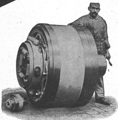
Benn Kupplung Nr. 12 für 600 PS geliefert in eine Zementfabrik.
