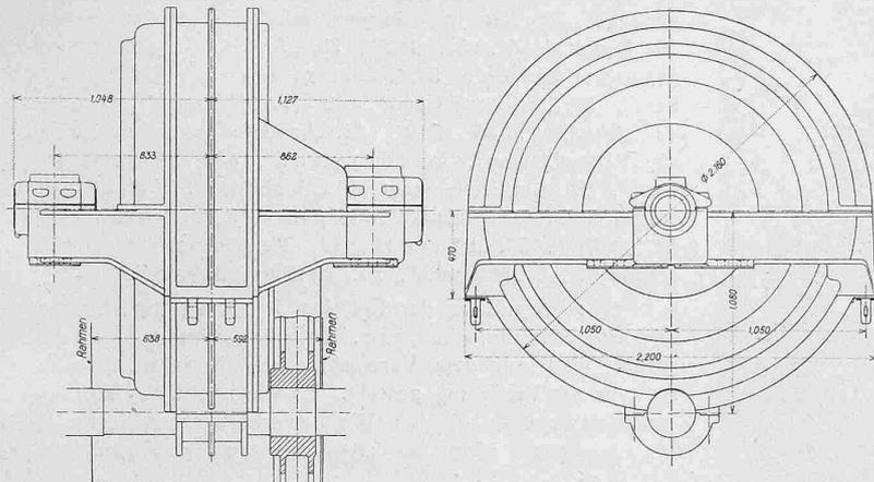
Abb. 72. Umrisszeichnung des 1250 PS-Motors der Lötschberg-Lokomotiven. — 1 : 40.
