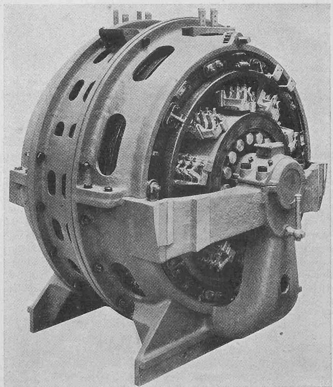
Abb. 71. 400 PS-Einphasen-Seriemotor für die Rh. B.-Lokomotive.
