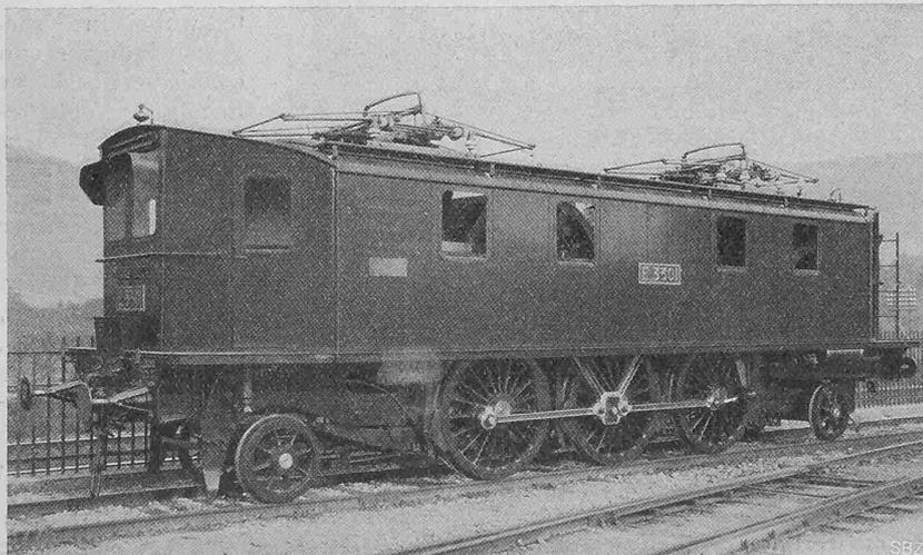
Abb. 6. Einphasen-Wechselstrom-Versuchslokomotive 1-C-1 (Chemins de Fer du Midi).
