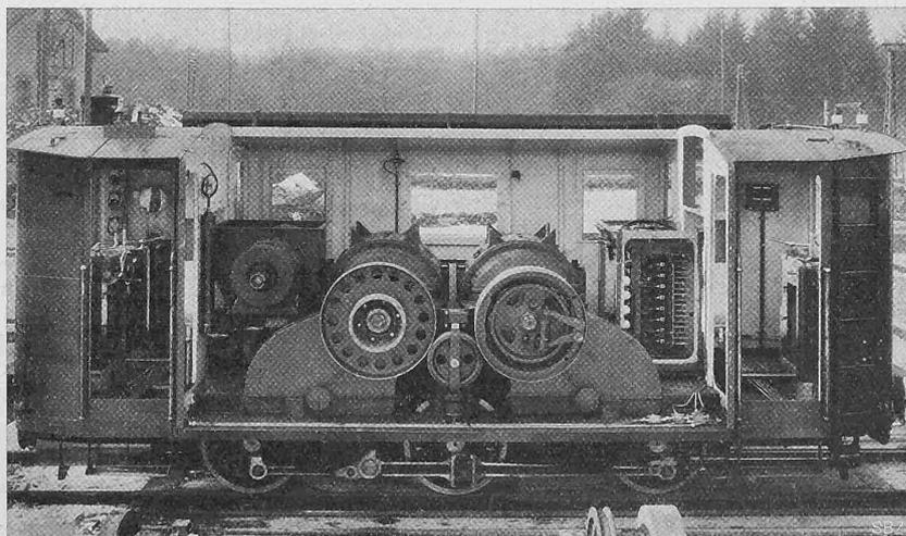
Abb. 11. Lokomotive der Berner-Oberland-Bahnen, mit abgenommener Kastenwand.
