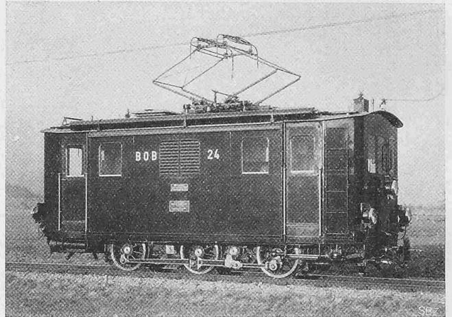
Abb. 12. Gleichstrom-Lokomotive o-C-o für die B. O. B.
