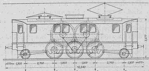
Abb. 5. Einphasen-Wechselstrom-Versuchslokomotive. — 1 : 200.
