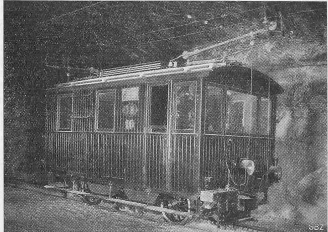
Abb. 14. Dreiphasen-Wechselstrom-Lokomotive o-B-o für die J.-B.
