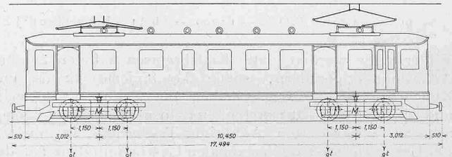
Abb. 18. Gleichstrom-Motorwagen der Chur-Arosa-Bahn. — 1 : 200.
