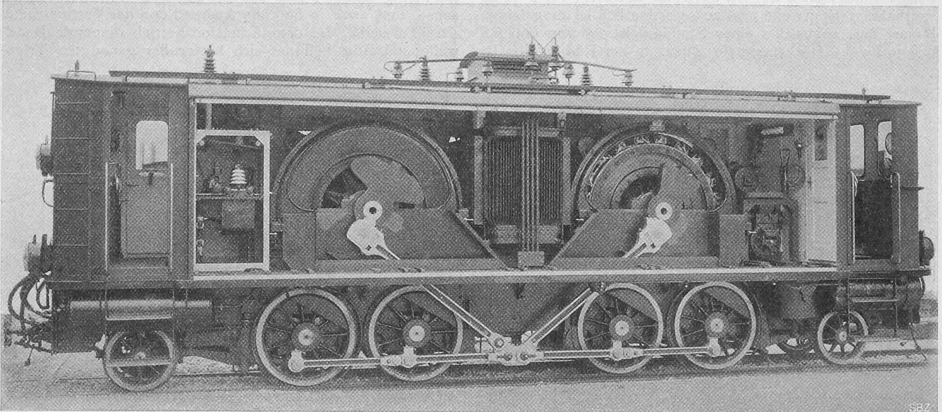
Abb. 8. Einphasen-Wechselstrom-Lokomotive 1-D-1 für die Rhätische Bahn, mit abgenommener Seitenwand.
