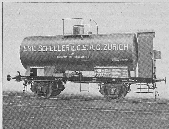
Abb. 61. Zisternenwagen; Tara 11,15 t, Ladegewicht 16,15 t. Beide Wagen erbaut von der Schweizerischen Wagons-Fabrik Schlieren.
