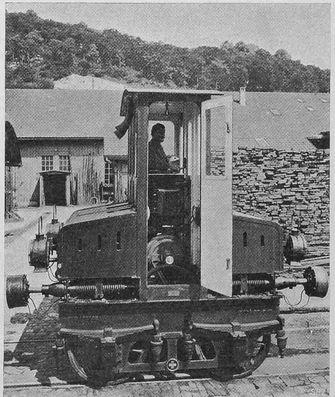
die durch den Fahrshalter beim Anfahren parallel, beim Betrieb in Serie geschaltet werden; Kapazität = 120 Ampèrestunden, maximaler Lade- und Entladestrom = 40 Ampère; Gewicht beider Batterien zusammen = 1400 kg.
