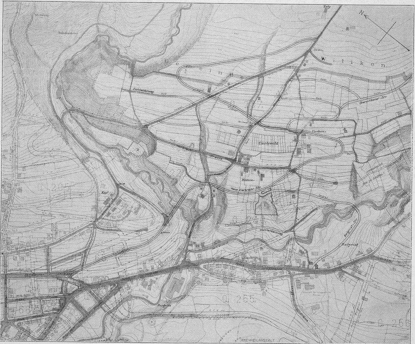
Abb. 22. Uebersichts-Strassenplan. — Masstab 1:7500. — Erklärung: Dunkel angelegt sind die beibehaltenen, bestehenden Strassen und Fusswege, sowie die durch genehmigte Baulinien der Bebauung bereits entzogenen Flächen; mit I bis IV bezeichnet sind die als Bauland ungeeigneten Flächen, deren Freihaltung durch Ankauf (bei III zwecks Wiederaufforstung) wünschenswert und mit mässigem Aufwand möglich ist.
