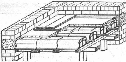
Billigste, feuer- und schallsicherste Decke der Gegenwart. Für alle Lasten und Spannweiten, keine geschlossene Schalung, einfachste Herstellung. Wenig Gewicht, wenig Beton, sehr leichter Hohlstein, welcher genau alle neutralen Teile ausfüllt. Deckensteinlieferung jeden Quantum stets sofort nach allen Bahnstationen Europas, weil in den meisten besseren Ziegeleien erzeugt und vorrätig gehalten werden.
