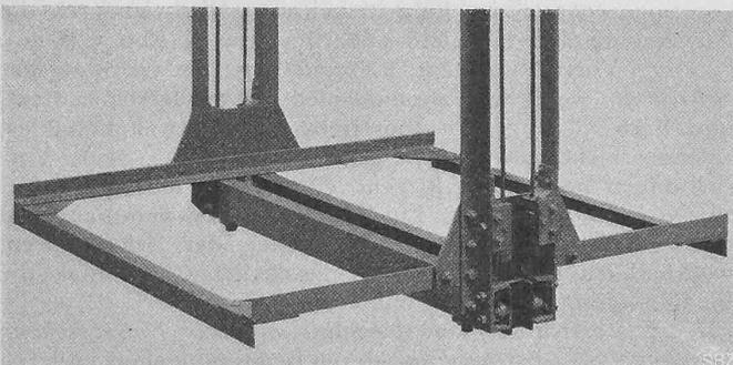
Abb. 6. Unterer Teil der Fangvorrichtung Bauart «ARSAG».
