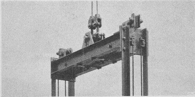
Abb. 5. Oberer Teil der Fangvorrichtung Bauart «ARSAG».
