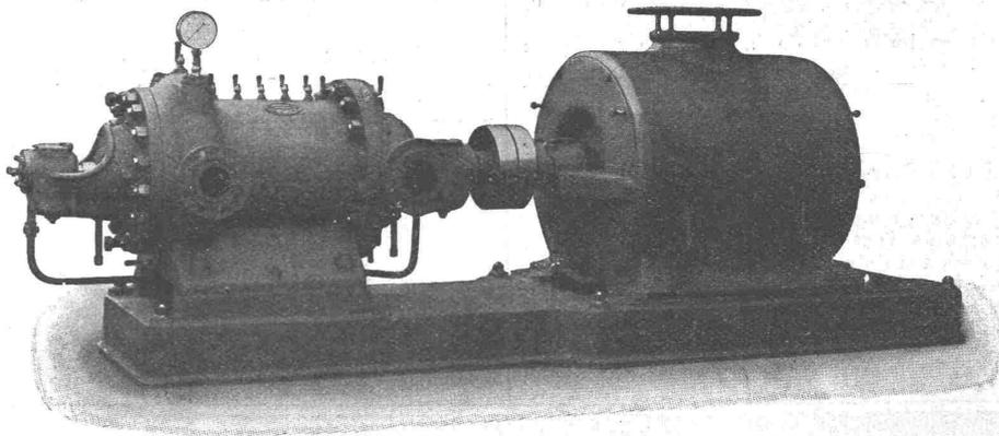
Sulzer-Hochdruck-Zentrifugalpumpe direkt gekuppelt mit Elektromotor.
