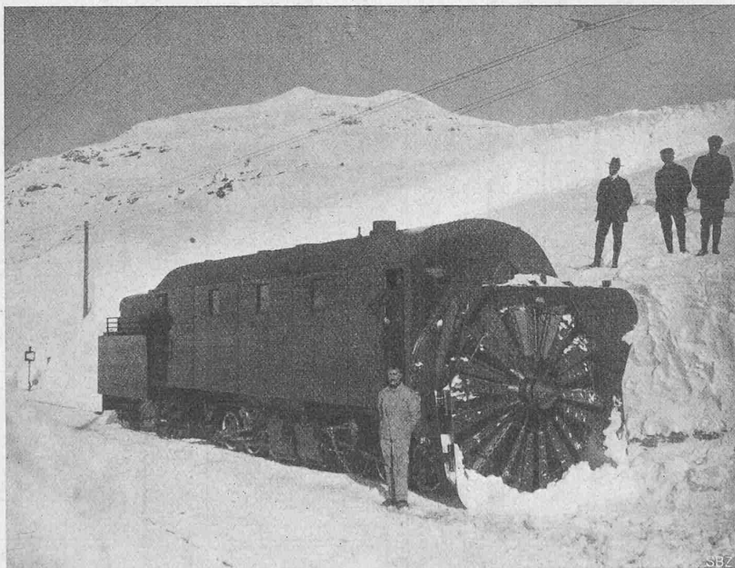
Abb. 3. Schneeschleudermaschine von vorn.
