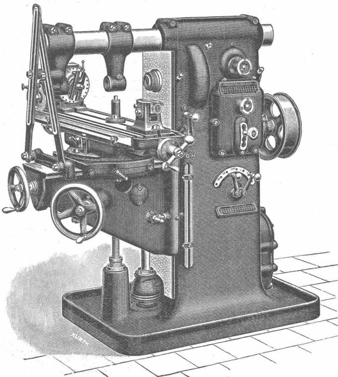
Wanderer-Rapid-Fräsmaschine Nr. 2 mit Einzelplatten-Antrieb.
