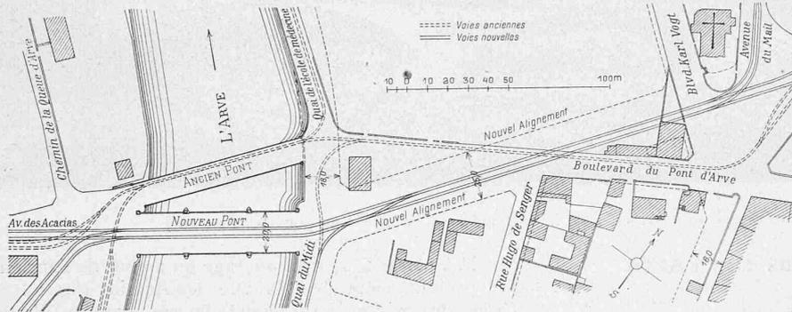
Fig. 2. Plan de situation de l'ancien et du nouveau pont. — Echelle 1:3000.
