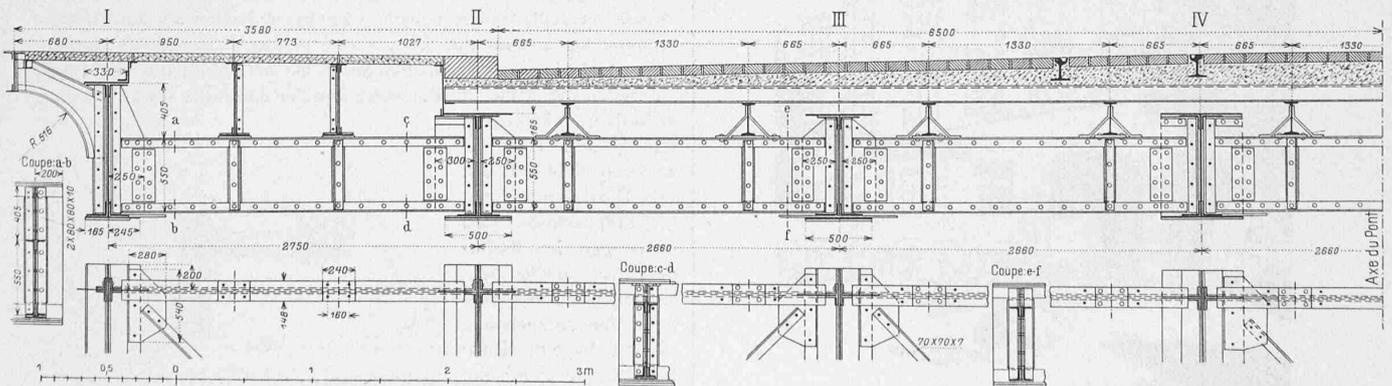
Fig. 8. Coupes transversale et horizontale sur culées. — Echelle 1 : 50.
