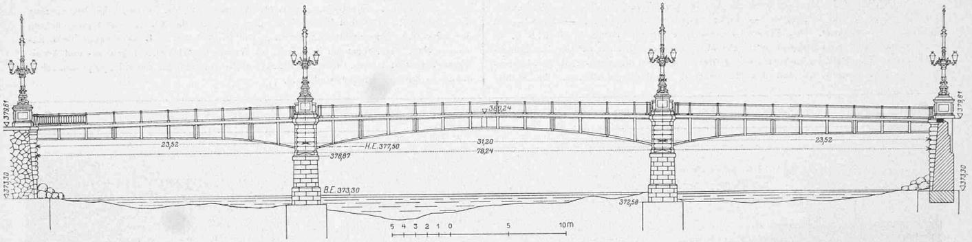
Fig. 3. Elevation du nouveau pont des Acacias. — Echelle 1:400.
