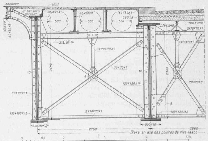
Fig. 9. Coupe transversale sur piles. — Echelle 1:50.
