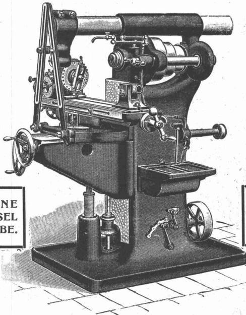
UNIVERSAL-FRÄSMASCHINE NR. 2 MIT VORSCHUBWECHSEL DURCH ZAHNRÄDERGETRIEBE.
