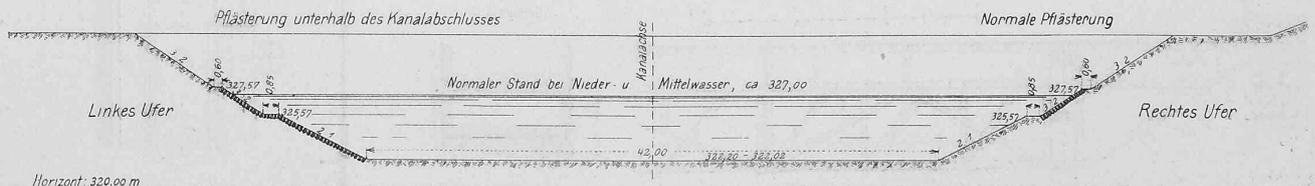
Abb. 14. Querschnitt des Oberwasserkanals. — Masstab 1 : 500.
