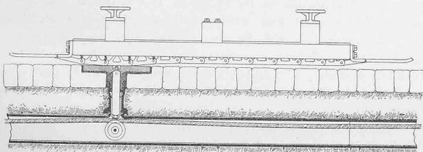
Abb. 2. Längenschnitt durch den Wagenmagnet und den Stromabnehmer.
