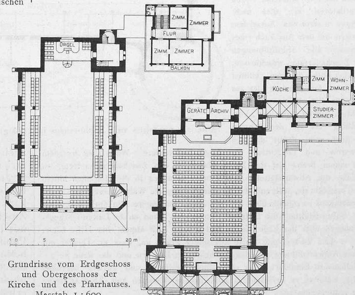
Grundrisse vom Erdgeschoss und Obergeschoss der Kirche und des Pfarrhauses. Masstab 1 : 600.
