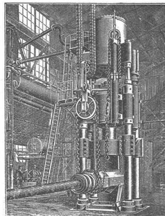
Dampfhdraulische Schmiedepresse. Stahlformguss bis zu 50 000 kg Stückgewicht.
