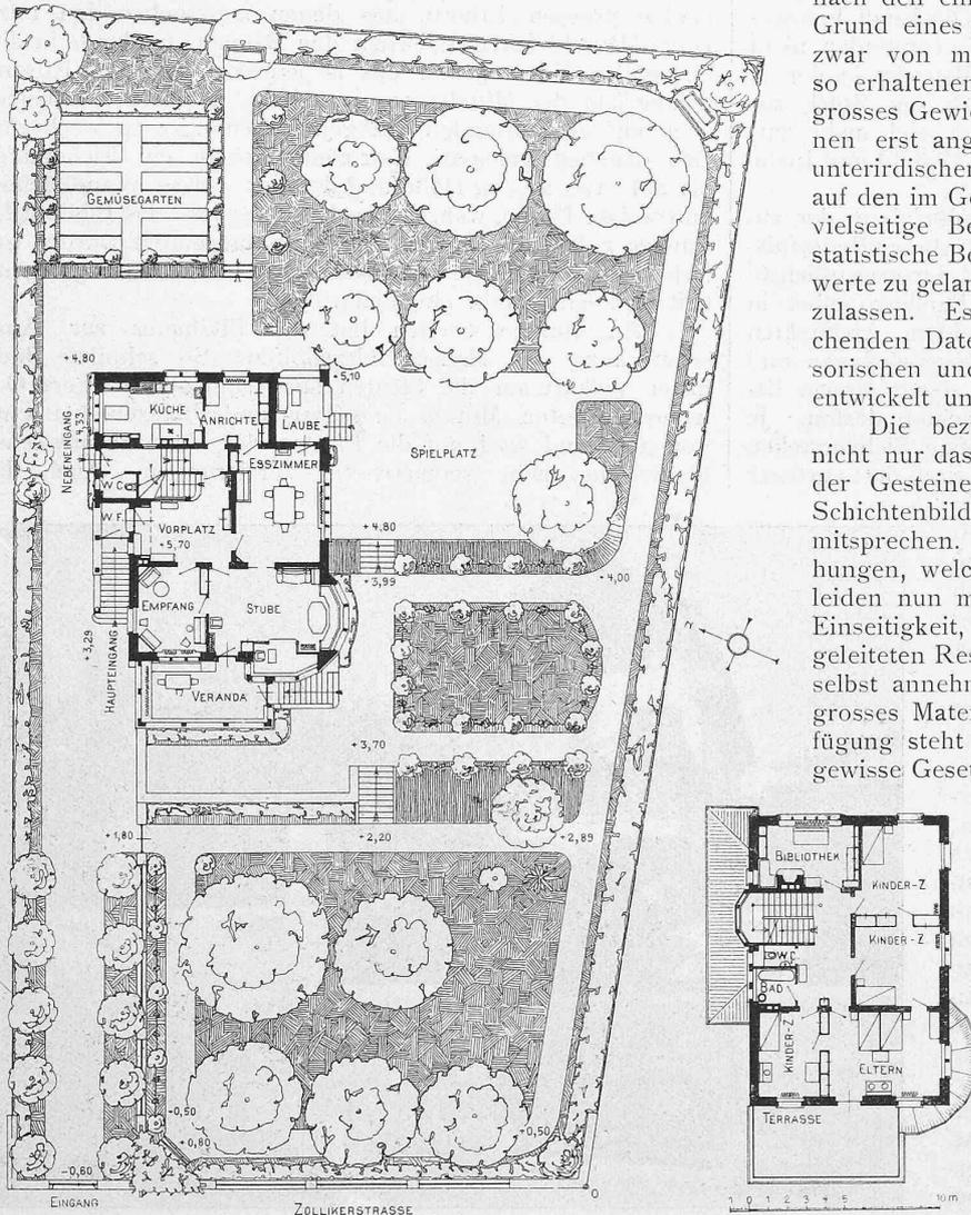
Abb. 2 u. 3. Grundrisse vom Erdgeschoss und ersten Obergeschoss sowie Lageplan des Gartens.
