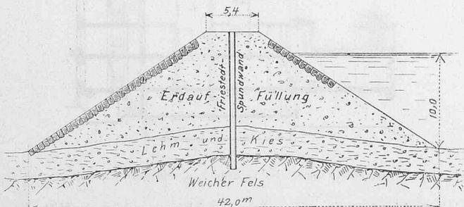
Abb. 4. Anwendung einer Friedstedtschen Spundwand aus Flusseisen. Masstab 1 : 500.
