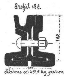
Die bisherige beste Lösung der Stossfrage ist Anwendung der Fusslaschen. Die Fusslasche garantiert dauernd stossfreies Befahren. Weichen und Kreuzungen bewährtester Bauart mit neuester Zungenbefestigung, Federung und Entwässerung. Normale Verlaschung mit Blattstoss-Halbstoss bezw. Fusslaschen an allen Weichenstössen. Aufaufweichen zu Notgleisen. Hilfsgeräte zu Gleisverlegungsarbeiten, Lochpresse, Biegebügel.
