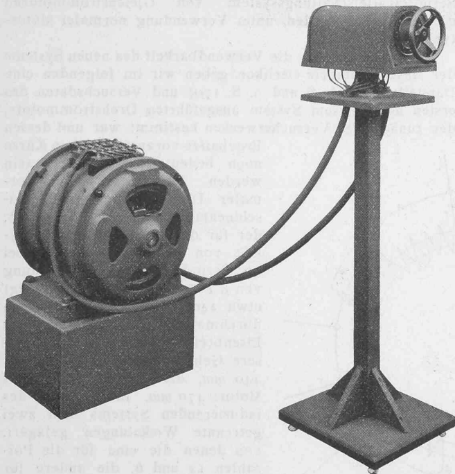
Abb. 8. Vierstufen-A-Motor, System Oerlikon. — Montiert. Umdrehungszahl: 500, 750, 1000 und 1500. Leistung 4—6 P. S.
