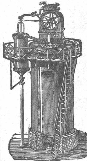
zur Reinigung u. Weichmachung des Wassers für Dampfkessel, Bleichereien, Färbereien, Wäschereien, Gerbereien, Papierfabriken und Entfernung von Oel, Fett und Eisen aus dem Wasser.
