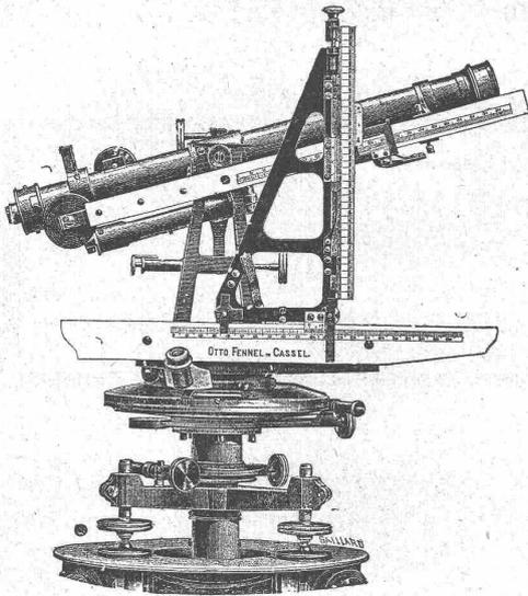
Vorzüglich bewährt für Vorarbeiten zu Eisenbahnen, Strassen, Canälen und Landesmeliorationen. Ableseung der Horizontalentfernungen und Meereshöhen oh. alle Rechnung unmittelbar am Instrument. Grösste Genauigkeit, Uebersichtlichkeit u. Schnelligkeit der Feldarbeiten. Sehr verringerte Bureauarbeiten. Wesentliche Zeit- u. Geldersparnis.
