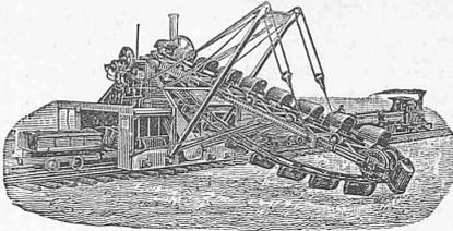
**Excavatoren (Trockenbagger)** zum **Eisenbahn- und Wasserbau,** für Abträge und Einschnitte, zum **Bergbau (Tagebau),** für Abraumarbeit und Braunkohlenförderung.
