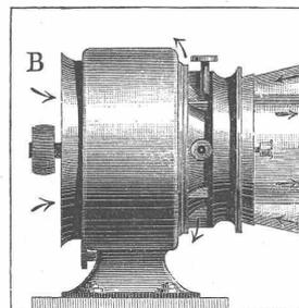
entweder direct von einer Druckwasserleitung aus durch **Turbine (A)** oder, wo Druckwasser nicht vorhanden, durch **Riemen** von einer Transmission aus betrieben (B), zur **rationalen** und **wirksamen** Ventilation von **Spinnereien, Webereien** und anderen **Fabrikräumen, Wirtschaftslocalen, Concertsälen, Restaurants** etc., gleichzeitig frische Luft eintreibend und die verdorbene absaugend, mit oder ohne **Luftbefeuchtung**. Kostenanschläge gratis.
