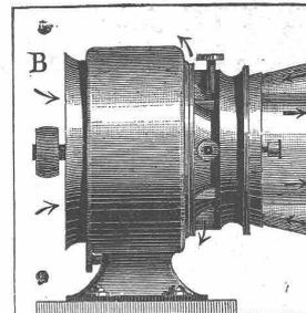
entweder direct von einer Druckwasserleitung aus durch **Turbine (A)** oder, wo Druckwasser nicht vorhanden, durch **Riemen** von einer Transmission aus betrieben (B), zur **rationellen und wirksamen** Ventilation von **Spinnereien, Webereien** und anderen **Fabrikräumen, Wirtschaftslocalen, Concertsälen, Restaurants** etc., gleichzeitig frische Luft eintreibend und die verdorbene absaugend, mit oder ohne **Luftbefeuchtung**. Kostenanschläge gratis.
