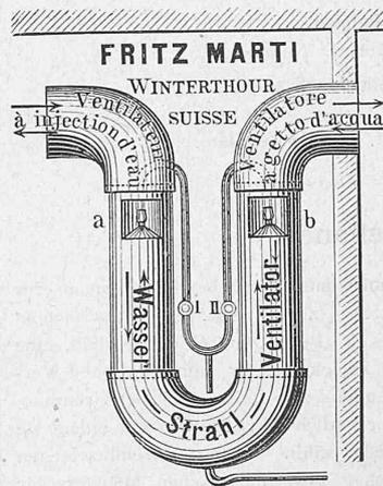
Fig. 3 zeigt einen Ventilator für grosse Räume (Säle, Fabriken, Ställe etc. etc., Zwischendecks für Auswandererschiffe etc. etc.), welcher zu zweifacher Function eingerichtet ist; öffnet man den Hahn II, so wird frische Luft in die zu ventilirenden Räume eingeführt, öffnet man dagegen den Hahn I, so wird die Luft aus den zu ventilirenden Räumen abgesaugt.
