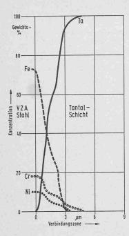
Konzentrationsverlauf Ta, Fe, Cr und Ni in der zwischen Verbindungszone V2A-Stahl und Tantalschicht. Schon bei einer Schichtdicke von 3 µ Tantal ist der Tantalanteil in der Verbindungszone auf rund 95 % gestiegen. Ab 5 μ ist auch der Chromanteil in der Verbindungszone nicht mehr nachweisbar. Die Oberfläche des Werkstücks verhält sich wie reines Tantal. Die Abscheidungstemperatur betrug bei dem Versuch 1370 K
