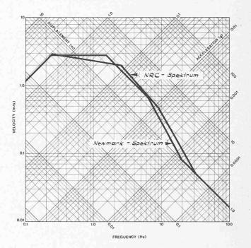
Bild 16. Bemessungsspektren. Horizontale Bemessungsspektren (Mittelwert plus eine Standardabweichung) für Lockergestein und verwitterten Fels, skaliert auf 1,0 g Horizontalbeschleunigung, Dämpfung  $\beta=5$  Prozent
