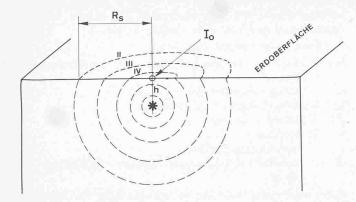
Bild 3. Ausbreitung eines Erdbebens. An der Erdoberfläche kann das Schüttergebiet (Schütterradius  $R_s$ ) durch Isoseisten unterteilt werden (Linien mit Intensität II, III, IV, ...)  $I_0$  = Epizentralintensität, h = Herdtiefe
