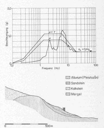
Bild 19. Lokaleinflüsse. Ermitteltes Verhaltensspektrum der Station Cornino-Forgania (Friaul, 6. Mai 1976) im Vergleich mit einem Bemessungsspektrum nach Newmark (unten). Deutlich kommt der spezifische Lokaleinfluss im Vergleich zum gemittelten Verhaltensspektrum zum Ausdruck
