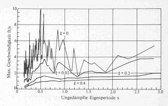
Bild 15. Typisches Verhaltensspektrum. Verhaltensspektrum der Schwinggeschwindigkeit eines Einmassenschwingers bei 0, 2, 20, 40 Prozent Dämpfung, angeregt durch das El-Centro-Erdbeben (Kalifornien 1940)
