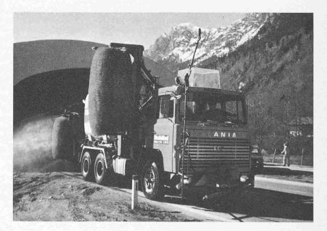
Gesamtansicht: Tunnelreinigungsmaschine CH 7
