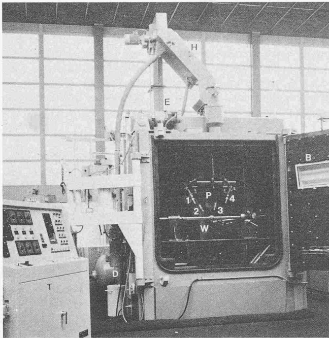
Bild 16. Nach dem Druckluft-System arbeitende, mit insgesamt fünf verstellbaren Injektorstrahlpistolen ausgerüstete Shot-peening-Kabine. Strahlmittelzuführung mit Becherwerk nach Gravitationssystem. Schaltpult mit Programmvorwahl für alle wesentlichen Parameter. W zu behandelnde Nockenwelle, E Becherwerk, H Kaskadenabscheider, B Beleuchtungseinrichtung, T Schaltpult mit Programmvorwahl für Strahlzeit, Bewegungsabläufe der Düsenköpfe usw., P Injektorstrahlpistolen: No. 1 und No. 4 führen Translationsbewegung entlang der Welle aus, No. 2 und No. 3 sind stationär auf die Seitenflächen der Nocken ausgerichtet, D zentraler Druckluftbehälter (Werkphoto: Société Bugatti S.A., Molsheim)
