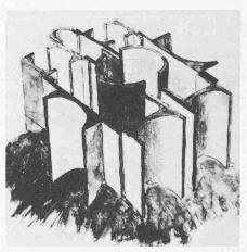
Wesentliche Formerkenntnisse bei der visuellen Analyse der Gerüstklammer wurden in einen Schaumstoff-Würfel projiziert, die herausgeschnittenen Positiv- und Negativformen in Grundriss, Aufriss und Schnitt zeichnerisch studiert und Anwendungen ausprobiert
