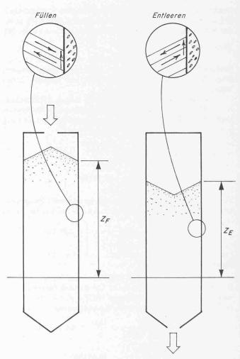
Bild 1. Reibung des Silogutes beim Füllen und Entleeren
