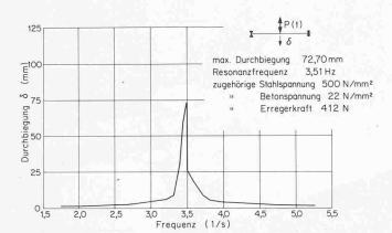
Bild 8. Resonanzversuch, Durchbiegungen in Balkenmitte
