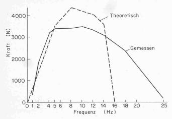
Bild 3. Kraft-Frequenz-Grenzkurve des Schwingungserregers für eine Masse von 104 kg
