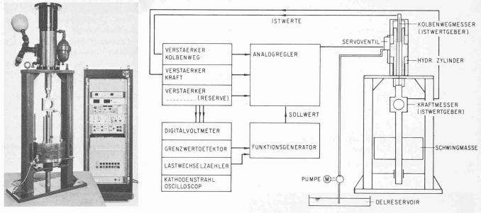
Bild 1. Servohydraulischer Schwingungs- Bild 2. Schema der Steuerung (Regelkreis) erreger
