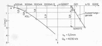
Bild 5. Kraft-Setzungslinie (über Punkt 12)
