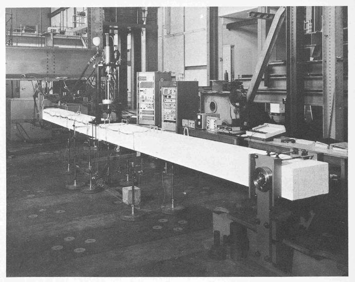
Bild 6. Schwingungsversuch an einem Leichtbetonbalken
