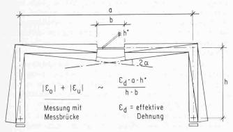
Bild 5. Geometrie des Dreigelenk-Dehnungsmessrahmens
