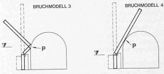
Bild 4. Beispiel von Bruchmechanismen eines Abluftkamins infolge Flugzeugabsturz
