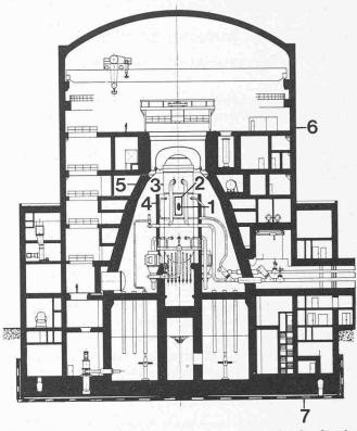
Bild 1. Barrierenkonzept am Beispiel des Reaktorgebäudes für das Kernkraftwerk Kaiseraugst
