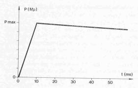
Bild 3. Beispiel des zeitlichen Verlaufes einer Strahlkraft
