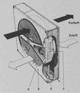
Schema: a) Rotor mit hygroskopischer Speichermasse in Lamellenstruktur, b) Stahlblechgehäuse für Kanalanschluss oder Kammereinbau und Abdichtleisten zwischen Gehäuse und Rotor, c) Doppel-Spülkammer zwischen den Luftströmen zur Vermeidung eines Luft-übertritts in der Rotordrehrichtung, d) Rotorantrieb über Getriebemotor mit Keilriemen
