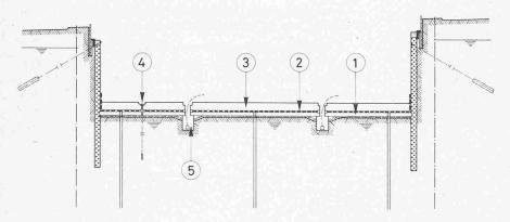
Phase c, 1 Aussenwanne, 2 Isolation, 3 Innere Wanne, 4 Anker gegen Auftrieb (mit Stutzen), 5 Sickergruben mit Pumpen (in Betrieb)
