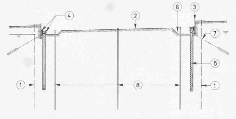
Phase a, 1 Piezometer, 2 1. Aushub, 3 Rühlwand, 4 Bentonit Führungsmauer (innere Führungsmauer abgebrochen), 5 Bentonitwand mit Vorspannkabel, 6 Bohrplanum für Rückverankerung, 7 Verankerung Bentonitwand, 8 Filterbrunnen
