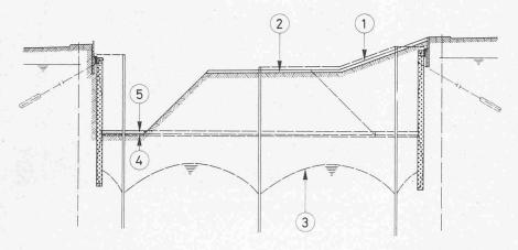
Phase b, 1 Aushub-Rampe, 2 Bekiestes Aushubplanum, 3 Grundwasserabsenkung, 4 Filterschicht, 5 Aussenwanne (in Bentonitwand eingelassen)
