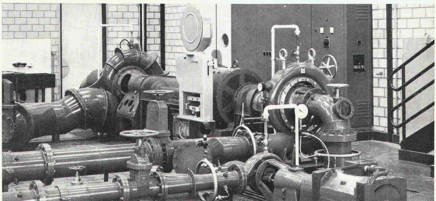
**Bell** Die Bell Maschinenfabrik AG, Kriens, hat die gesamte hydraulische Labor- ausrüstung, bestehend aus Pelton-, Pump- und Kaplan- turbinen sowie Mess- und Regeleinrichtungen geliefert. Bell hat eine grosse internationale Erfahrung auf dem Gebiet der hydrau-
