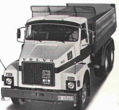
Volvo N 12 Dreiachser: Gesamtgewicht 25 t, Fahrgestellgewicht inkl. elektr. Wirbel-strombremse ca. strömbremse ca. 8,21.
