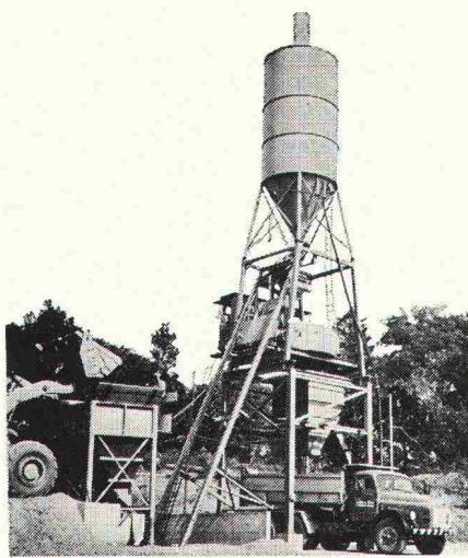
Standard-Betonanlagen AEBI, 4 Typen zwischen 20 m<sup>3</sup> und 60 m<sup>3</sup> Festbeton pro Stunde.
