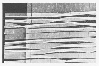
Bild 7. Splitterfibergarne (weitere Entwicklung von Bändchengeweben)
