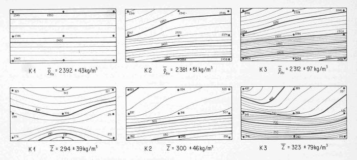
Bild 1. Entmischungserscheinungen in den Wänden [2]. Kurven: gleiche Trockenrohdichte pRtr (oben) bzw. gleicher Zementgehalt Z (unten), Äquidistanz = 10 kg/m³; Zahlen: ausgeglichene Werte in kg/m³
