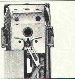
Der seitliche Zwangsantrieb durch Stahlscherenglieder ist garantiiert:
