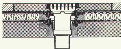
Flachdachablauf Guss zweiteilig mit Kugelrost, Isolierring, Isolierkörper, Distanzringe 25 + 35 mm Höhe, auch mit Flachrosten rund oder quadratisch lieferbar.
