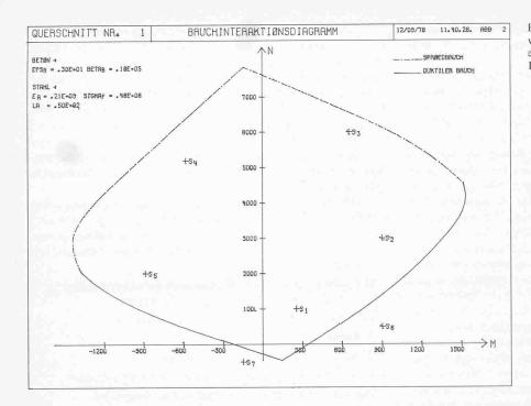
Bild 1. N-M-Bruchinteraktionsdiagramm eines vorgespannten Stahlbetonquerschnittes mit eingetragenen Schnittkraftpaaren (STATIK-Programm)
