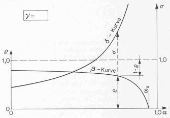
wenn  $\alpha \geq \alpha_s \rightarrow \text{kein Kondensat}$
