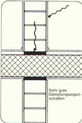
Pronouvo 1073 vermag grosse Lasten zu übertragen und ist auch hochbelastet ein wirkungsvolles Körperschall-Isoliermittel. Dank den ausgezeichneten Dämmeigenschaften sowie des guten statischen Verhaltens wird Pronouvo 1073 erfolgreich eingesetzt:
