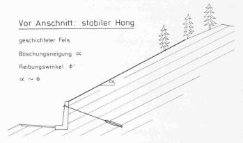
Bild 5. Einfluss eines Anschnittes in einem Hang mit einer Felsschichtung parallel zur Oberfläche für  $\alpha\sim~\varnothing$
