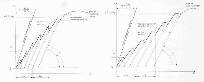
Bild 11. Links: Ankerversuch mit konstanter Kraft. Rechts: Ankerversuch mit konstanter Deformation
