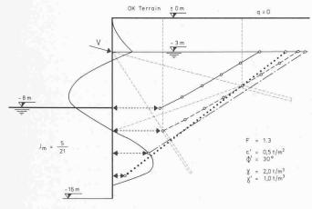
Bild 15. Beispiel zur Abschätzung der rechnerischen freien Ankerlänge  $l_{\rm fr}$  nach der vereinfachten Formel von Janbu. Die Punkte auf den Linien sind jeweils das Ende von  $l_{\rm fr}$  bzw. Anfang der Verankerungslänge
