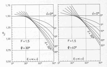
Bild 19. Wie Bild 18. Bestimmung von as, Methode Janbu
