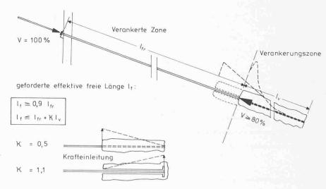
Bild 9. Schematische Darstellung der Krafteinleitung über das Zugglied in die Verankerungszone, mit der geforderten effektiven freien Länge  $I_f$  und den Bedingungen zur Kontrolle der Grösse der eingeleiteten Kraft und deren zuverlässigen Übertragung in den Verankerungskörper
