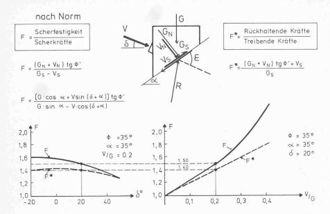
Bild 2. Einfluss der Definition des Sicherheitsgrades auf die errechnete Grösse von F, dargestellt anhand eines Beispieles mit zunehmendem Verhältnis der Ankerkraft V zur Masse G. Für V=0 ist  $F=F^*$
