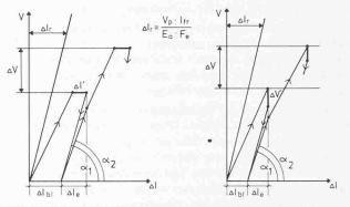
Bild 8. Schematische Darstellung des Kraft-Deformations-Diagrammes bei konstanter Kraft und konstanter Deformation, sowie anschliessender Entlastung und Wiederbelastung (mit der Grösse von  $\Delta l'$ , bzw.  $\Delta V'$  im Zeitintervall  $\Delta l$ ). Links: konstante Kraft, rechts: konstante Deformation
