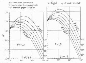
Bild 18. Ermittlung der notwendigen Ankerkraft aufgrund des Faktors  $a_F$ , Methode Fellenius, für bestimmtes T und R. Der Sicherheitsgrad F ist vorgegeben, der Neigungswinkel  $\delta$  des Ankers bzw.  $\epsilon$ , der Winkel zwischen Ankerrichtung und Gleitfläche wird gewählt
