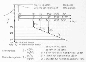
Bild 7. Zeitliches Verhalten eines Ankers infolge der Kraftstufe  $\Delta V$ , für Kraft konstant (Kriechen) bzw. Deformation konstant (Relaxation) mit der Kriechgrösse und der Relaxationsgrösse im log. Zeitmassstab
