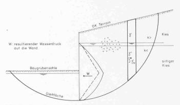
Bild 17. Dito Berechnung mit der Masse unter Auftrieb und der vektoriellen Strömungskraft J
