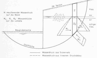
Bild 16. Stabilitätsberechnung zur Kontrolle der freien rechnerischen Ankerlänge bzw. der Gewährleistung der Stabilität durch die Einführung der Ankerkraft in die Berechnung. Berechnung mit totaler Masse mit den Wasserdrücken
