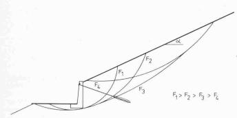
Bild 4. Betrachtung der Sicherheitsgrade  $F_i$  verschiedener Gleitflächen in einem labilen Hang mit homogenem Boden, d. h.  $\alpha \simeq \emptyset$
