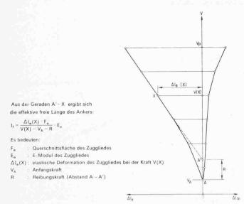
Bild 10. Diagramm der elastischen und bleibenden Deformation
