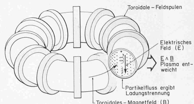
Einfaches Toroid-Magnetfeld, gebildet durch die geschlossenen Feldlinien, die durch einen Satz Spulen auf einem Torus erzeugt werden. Das System kapselt das Plasma nicht ein.
