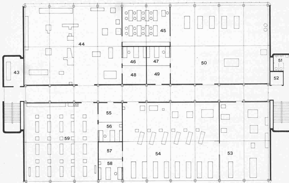
Werkstatt, Obergeschoss 1:400. 43 Späneabsaugung, 44 Maschinenraum für Schreiner und Zimmerleute, 45 Theorie, 46 Büro, 47 Büro, 48 Materialraum, 49 Materialraum, 50 Werkstatt Zimmerleute, 51 WC, 52 Putzraum, 53 Demonstrationsraum Mechaniker, 54 Werkstatt Mechaniker, 55 Materialraum, 56 Büro, 57 Materialraum, 58 Büro, 59 Werkstatt Schreiner, 60 Gang
