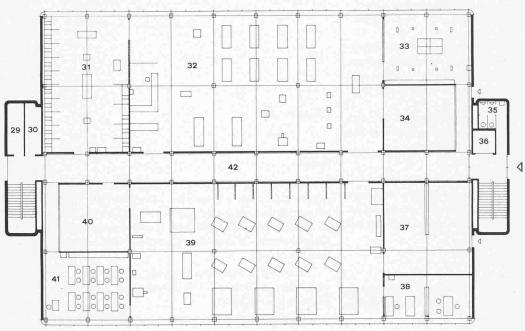
Werkstatt, Erdgeschoss 1:400. 29 Gasstation, 30 Lager, 31 Schweissraum, 32 Werkstatt Schlosser, Schmiedeleute, 33 Schmiederaum, 34 Materialraum, 35 WC, 36 Putzraum, 37 Materialraum Spengler, 38 Büro, 39 Werkstatt Spengler, Installateure, 40 Materialraum Installateure, 41 Theorieraum, 42 Gang
