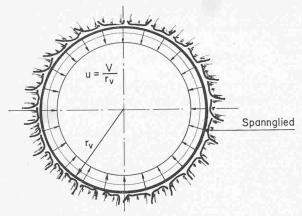
Bild 11. Ideale Kabelführung mit konstanten Umlenkkräften
