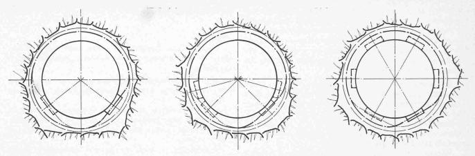
Bild 14. Mögliche «praxisgerechte» Anordnung der Verankerungsnischen innerhalb einer Gruppe benachbarter Kabel (Druckstollen)
