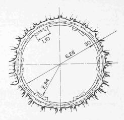
Bild 4. Aktive Vorspannung nach Dyckerhoff & Widmann
