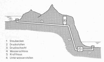
Bild 1. Schematische Darstellung einer Hochdruckwasserkraftanlage
