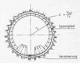
Bild 12. Praktische Kabelführung mit schematischer Darstellung der Umlenkkräfte
