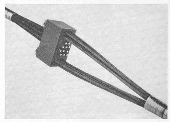
Bild 6. Zwischenverankerung VSL Typ Z
