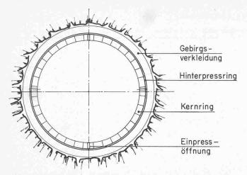
Bild 2. Kernauskleidung nach Dr. Kieser, Ausführung mit gemauertem Kernring
