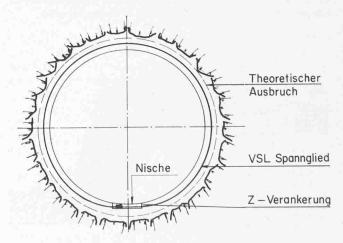
Bild 5. Vorgespannte Lösung System VSL
