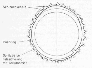
Bild 3. TIWAG-Spaltinjektionsverfahren
