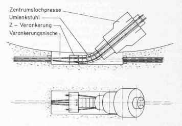
Bild 8. Schematische Darstellung des Spannvorganges
