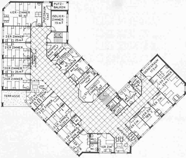
Grundriss 1. und 2. Obergeschoss 1:500, Pflegestation mit 26 Betten
